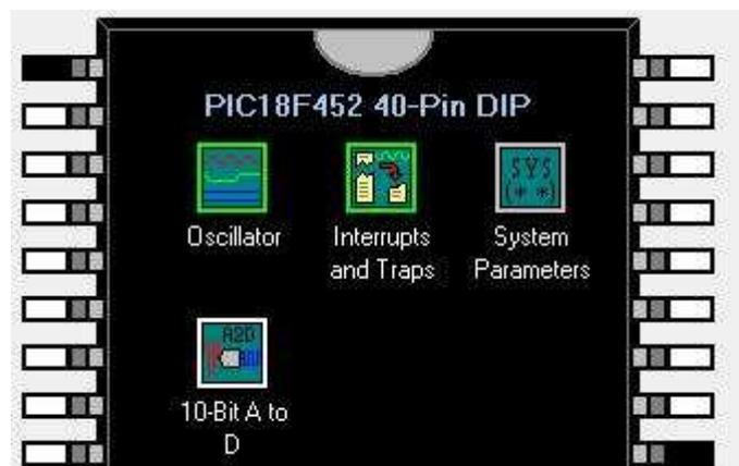
Double cliquer sur l'oscillateur et affecter la fréquence de 4MHz.
