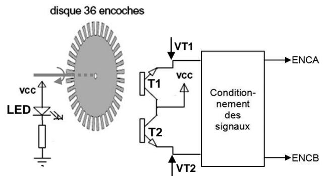
L'émetteur infra-rouge est une LED spéciale, les récepteurs sont deux photo-transistors T1 et T2. Le disque, lié à l'arbre de sortie du moteur, provoque, lorsqu'il tourne, la coupure et le rétablissement du faisceau lumineux entre la LED et les transistors. Il s'ensuit que les transistors sont alternativement bloqués ou saturés.
