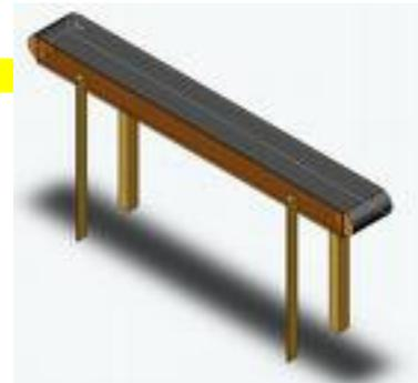
L'arbre de sortie du moto réducteur est solidaire de l'axe de la roue entraîneuse. Le tapis doit avancer à une vitesse de 0,5 m/s.
