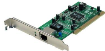
Figure 3: Carte réseau à l'intérieur du PC
