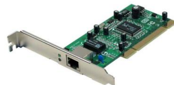
Figure 16: Carte réseau à l'intérieur du PC
