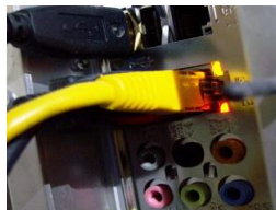
Figure 17: Prise réseau RJ45 à l'arrière du PC
