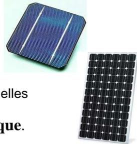
**Panneau ou Module Photovoltaïque** : Ensemble de cellules photovoltaïques interconnectées entre elles (généralement en série).
